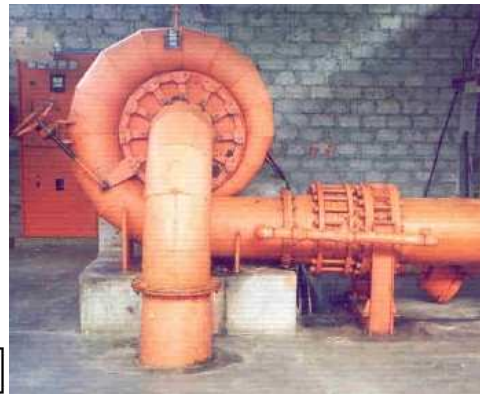
TURBINA FRANCIS. Fuente: CEDECAP.
