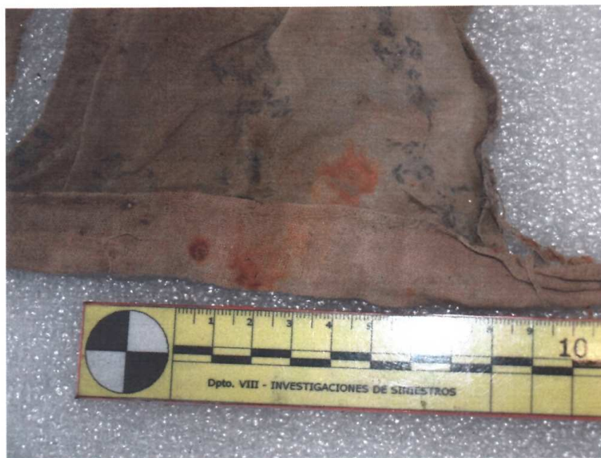
Documento Fotográfico N°4. Se observan manchas en la tela y sus dimensiones, pudiéndose determinar como en otras marcas dejadas por la oxidación de un metal en contacto con esta.
