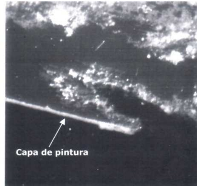
Figura 5. Muestra correspondiente a una zona del Trailing edge (bajo lupa). Se observa el avance del deterioro según la dirección de la cuerda de la sección, haciéndolo por debajo del área superficial pintada. La capa de pintura en la zona señalada por la flecha aparece sin daño mostrando que el avance de la superficie corroída proviene desde el extremo derecho.
